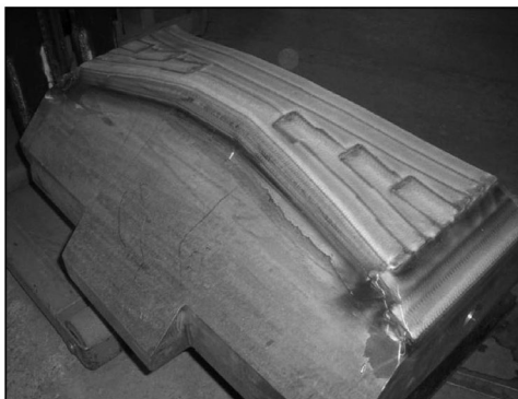
図 6. 鍛造用金敷への PPW 適用例.
