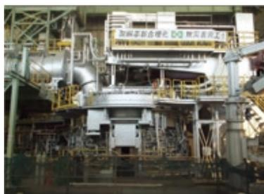
炉体旋回式電気炉の外観
