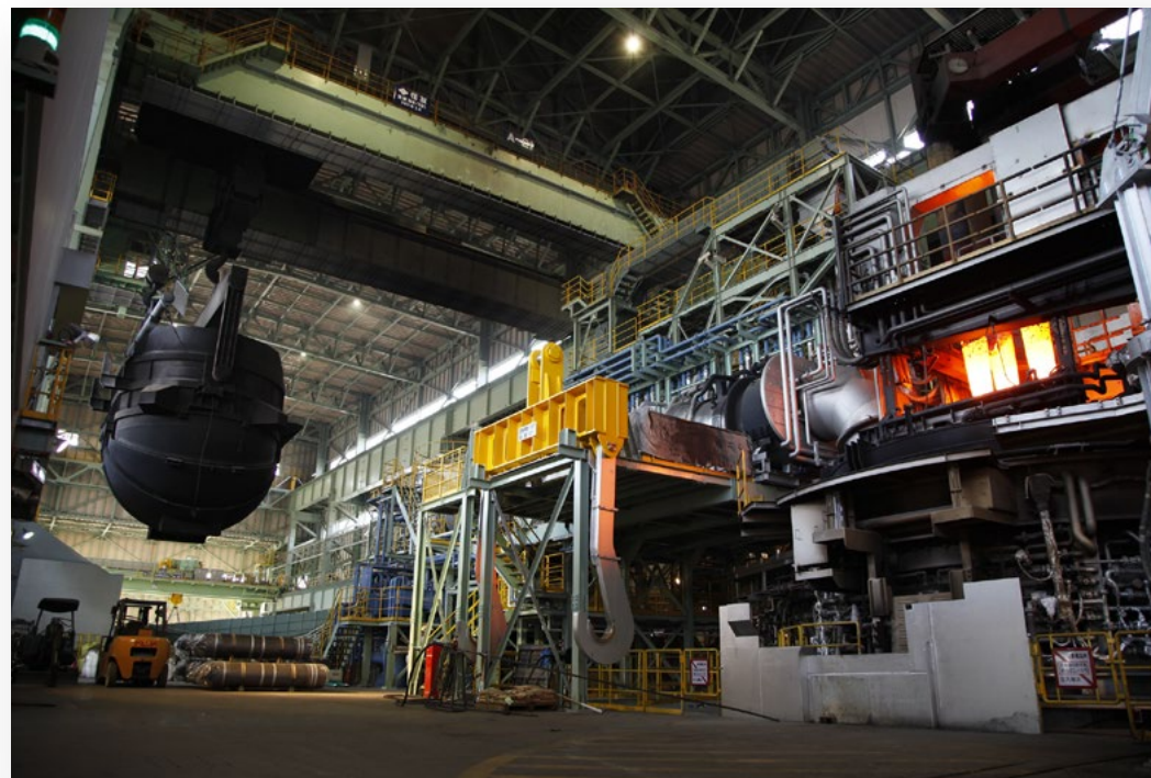
2026 150トン炉体旋回式電気炉「STARQ®」
