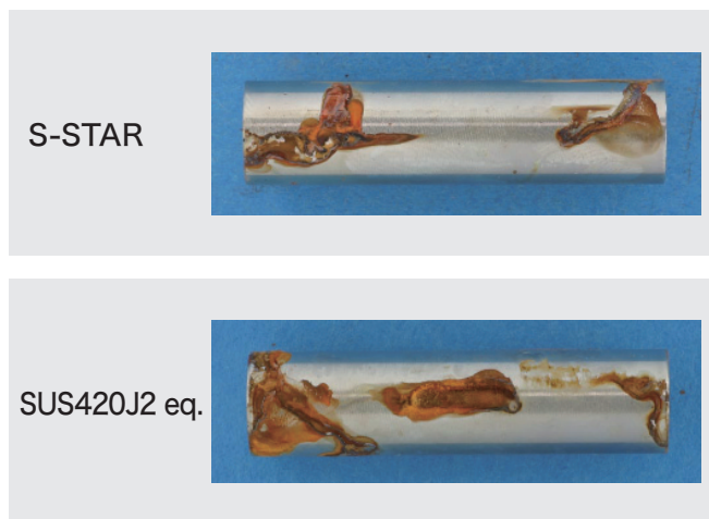
塩水噴霧試験: 5% NaCl, 48h
