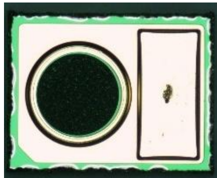
発光窓径 \phi 150\mu\text{m} ダイ寸法 360 \times 280 \times 150\mu\text{m}
