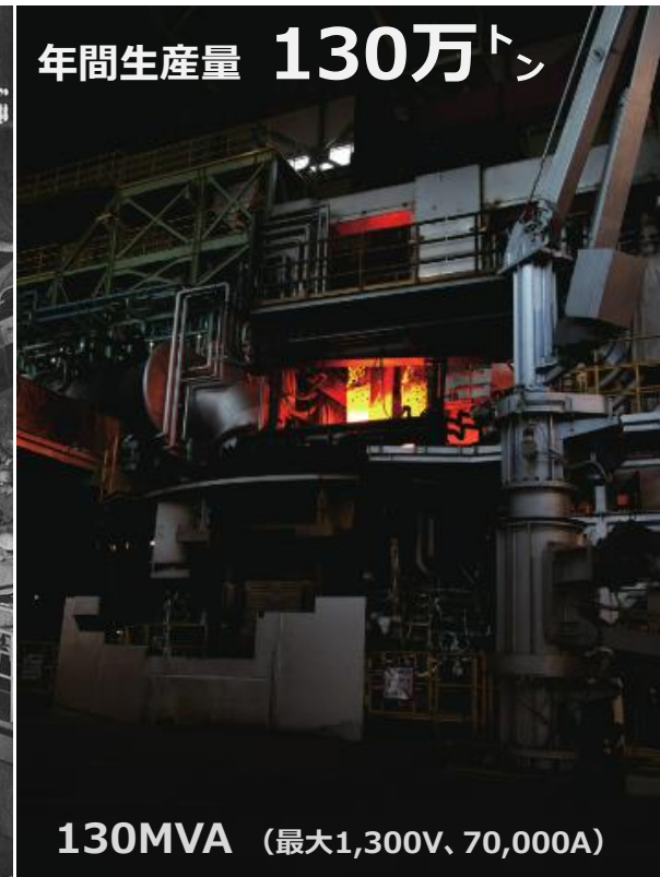
150ト、電気アーク炉 大同特殊鋼 知多工場
