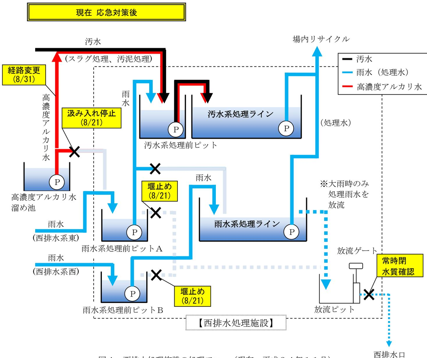
図4. 西排水処理施設の処理フロー (現在：平成24年11月)
