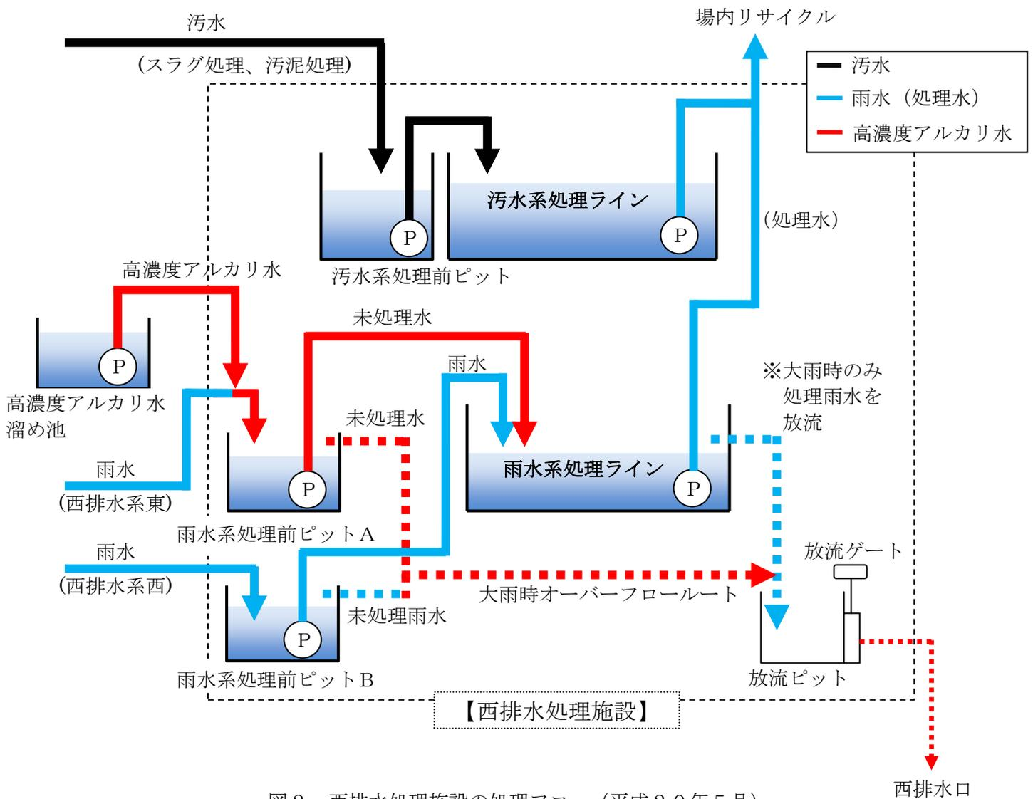
図2. 西排水処理施設の処理フロー (平成20年5月)
