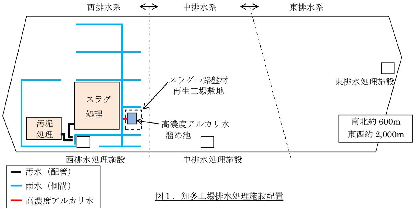
図1. 知多工場排水処理施設配置
