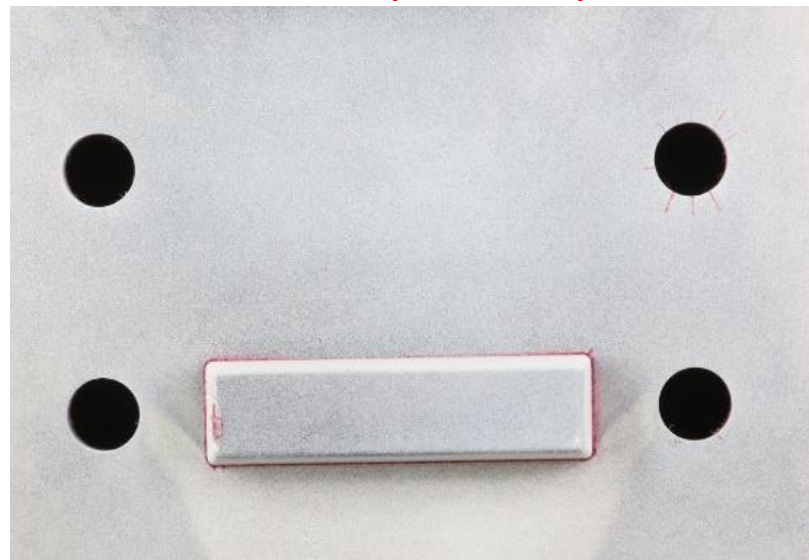
図5. 試験後の評価金型の外観比較(10,000サイクル後)
